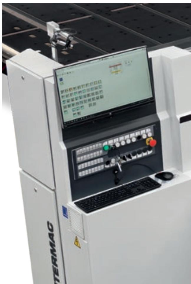
La interfaz del operador es sencilla e intuitiva y permite importar programas de corte generados por los optimizadores que se encuentran en el mercado gracias a la integración de la interfaz universal Optimizer Transferring Data (OTD) que define automáticamente los parámetros de corte y genera automáticamente el programa para la mesa de corte.
