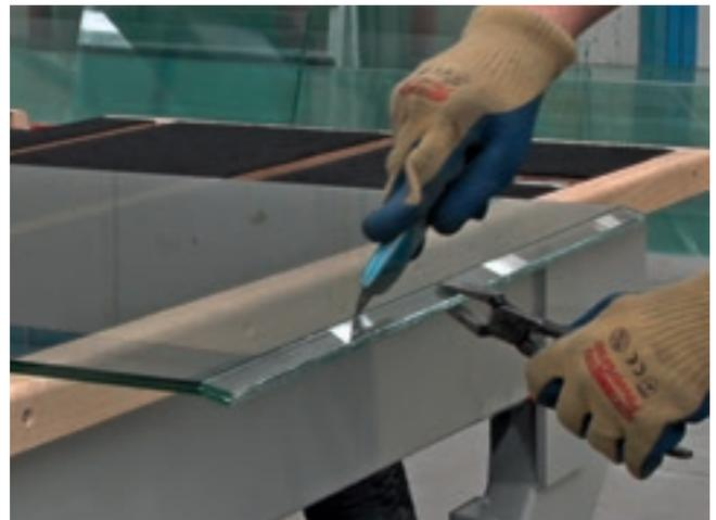
Corte + tronzado automático + separación manual 20 mm.
