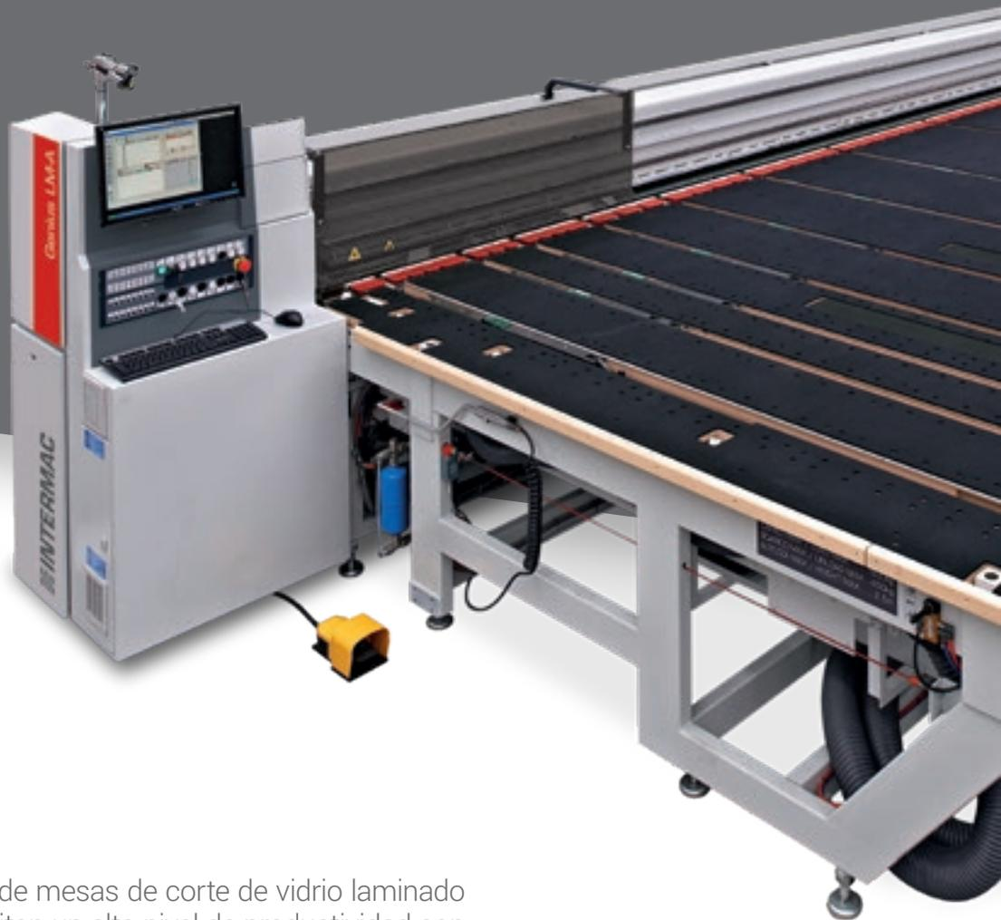
**Genius LM-A** es la gama de mesas de corte de vidrio laminado para empresas que necesitan un alto nivel de productividad con la posibilidad de automatizar el ciclo completo desde la carga hasta la descarga del volumen acabado. Soluciones muy innovadoras, patentadas por Biesse, que permiten integrar una línea para el laminado, pero en espacios muy reducidos y sin sacrificar la productividad.
